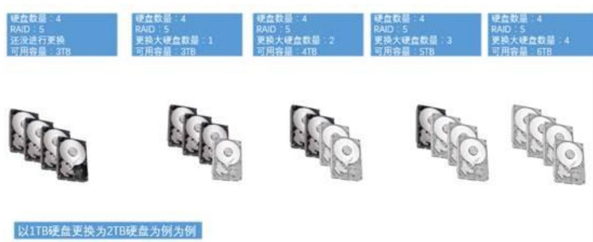
所謂縱向擴展，即硬碟由小容量更換為大容量。可以一塊一塊的將硬碟更換為大容量硬碟。在這個過程中，存儲的容量自動進行擴展。
